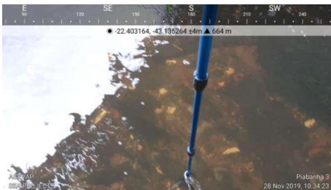
Figura 3.4-2: Fluxômetro diretamente na água durante a amostragem do Ponto 3.
